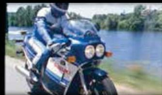
Megérkezett a gép, ami újraértelmezte a motorozás fogalmát. A GSX-R750-re örökre úgy fogunk emlékezni, mint az első igazi versenyreplika. 100 lóerőt állított elő, és csak 176 kilót nyomott, ezzel a nagyteljesítményű motorkerékpárok egy teljesen új kategóriáját teremtette meg.
