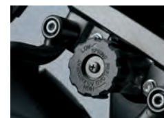
Könnyen állítható rugó-előfeszítés
