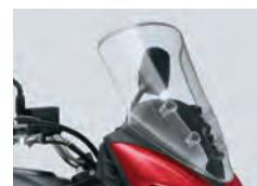
Három fokozatban állítható magasságú szélvédő
