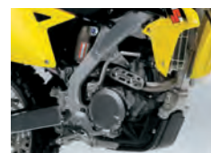
Könnyű, négyzelepes DOHC motor
