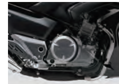
Folyadékhűtéses, soros kéthengeres blokk
