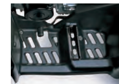
Teljes padlólemezek recézett acél lábtartókkal
