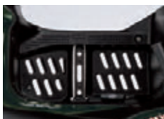
Teljes padlólemezek, szivárgófuratokkal
