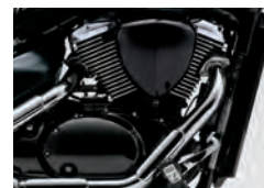
Folyadékhűtéses, 45 fokban döntött V2-es blokk
