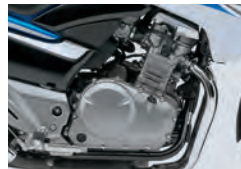
Négyütemű, kéthengeres, folyadékhűtéses, SOHC blokk
