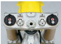
PSF2 első villák (A KYB pneumatikus rugós villája)
