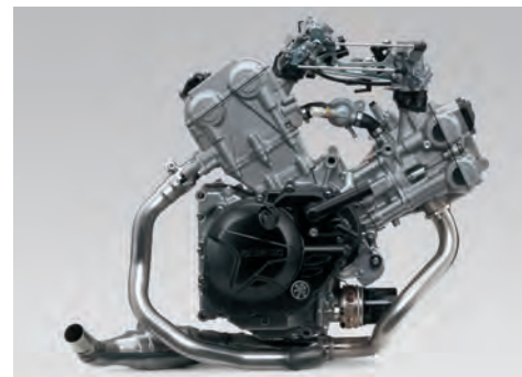
645 cm 3 -es folyadékhűtéses, DOHC, 90 fokban döntött V2 motor
