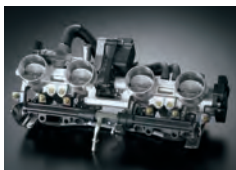
SDTV dupla pillangószelep
