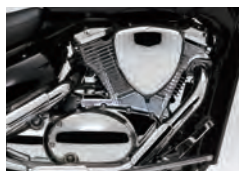
Folyadékhűtéses, 45 fokban döntött V2-es blokk
