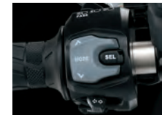
Suzuki Traction Control System (STCS) - két állású kipörgésgátló
